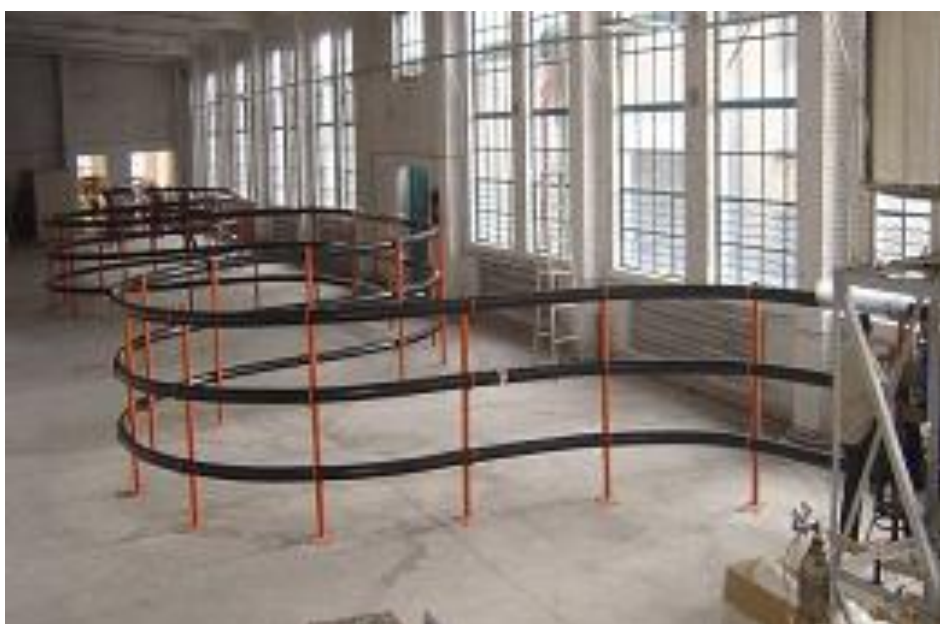
شکل (۲-۲۶): کابل انتقال برق سه فازی ابررسانای HTS بطول ۷۵ متر و با مشخصات ۱۰.۵ کیلوولت/ ۱.۵ کیلوآمپر در
