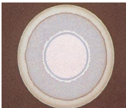
شکل (۲-۴): سطح مقطع سیم Nb 3 Sn
