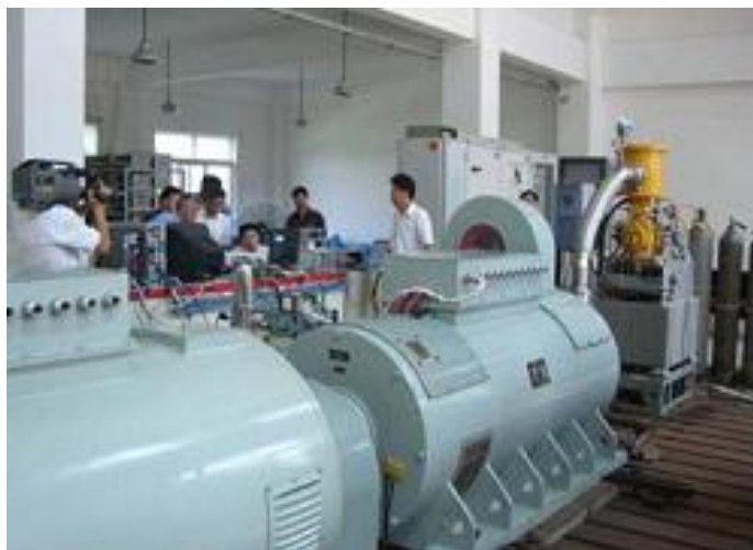
شکل (۲-۳۲): موتور HTS 100 کیلوواتی
